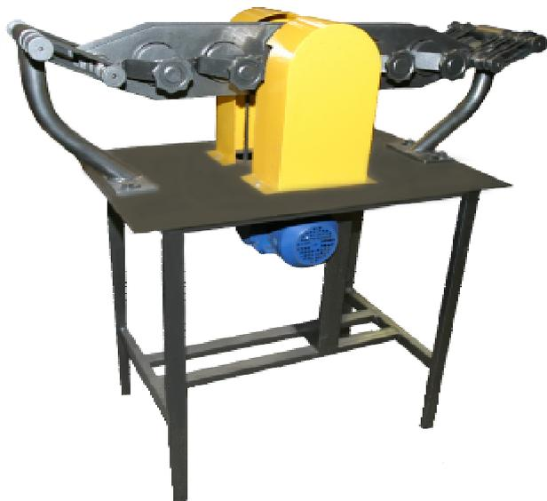
*Предназначен для механического доистирания проб различной твердости и прочности в периодическом режиме сухим способом.*
