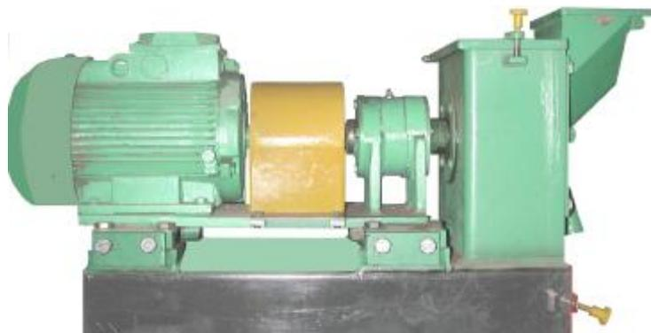
*Предназначены для порционного или непрерывного измельчения до порошкообразного состояния более крупных составляющих рудных и других твердых материалов*
